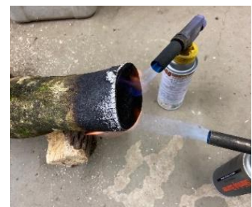
図 26 ガスバーナーでの焼入れ加工の様子
