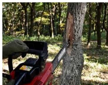
図 25 チェーンソーを利用した洞加工の様子
